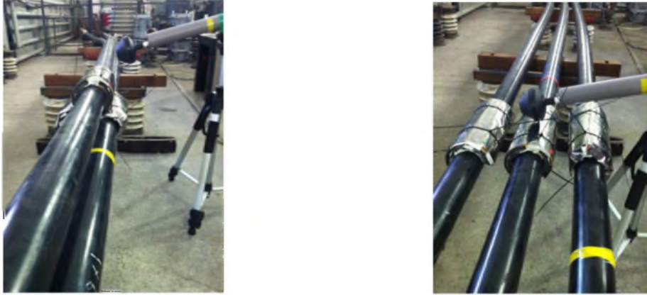
Рис.23 Измерение характеристик магнитного поля вблизи экранированной КЛ проложенной треугольником встык и в горизонтальной плоскости с просветом в диаметр кабеля.
